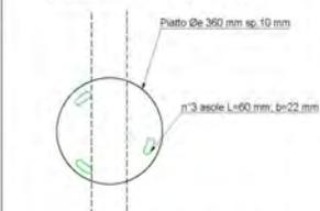
TIPOLOGICO PARTICOLARE CAPPELLOTTO DA VALUTARE IN FASE DI DIREZIONE LAVORI: TESTA DA ANCORARE SU MICROPALO ø219,1 sp.8 mm.
